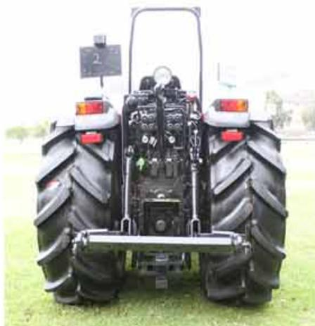
Un switch que baja y sube el implemento rápidamente que ahorra tiempo, proporcionando control del enganche de 3 puntos, haciendo vueltas más fáciles mediante el retorno del implemento al trabajo.
