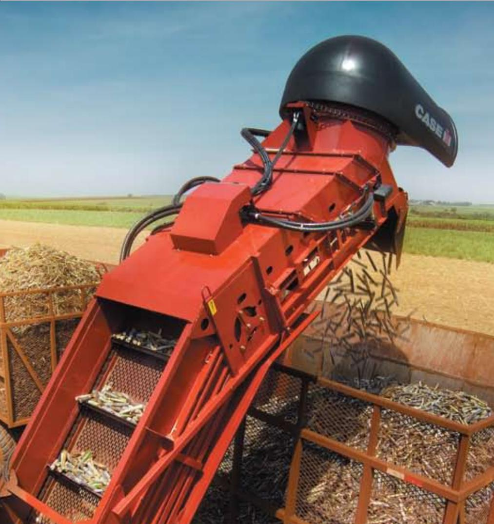
El elevador tiene una estructura más reforzada y está equipado con el sistema de giro Back-Hoe, confiable y mundialmente consagrado por la retroexcavadora Case 580 M y la serie A7000.
