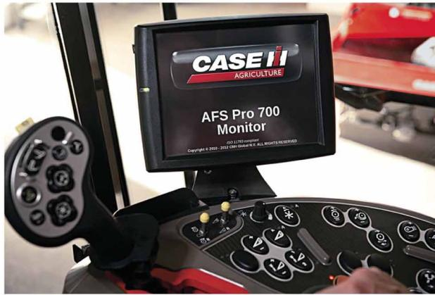
Equipada con monitor de rendimiento AFS PRO 700 como equipo estándar, usada como interfaz para calibrar sensores, vistas de rendimientos e información de pesos y humedad de los granos; rendimiento de monitor de combinada y control de funciones de la máquina.
