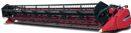
La Presión de la barra de corte se puede ajustar mientras se mantiene un amplio intervalo de la flexión para obtener un mayor ahorro de granos.
